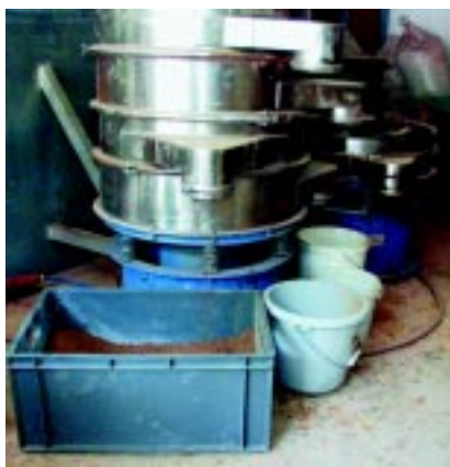
Bild 8: Vibrationsrundsiebmaschine im Technikum des Verfahrenstechnischen Instituts Saalfeld GmbH
