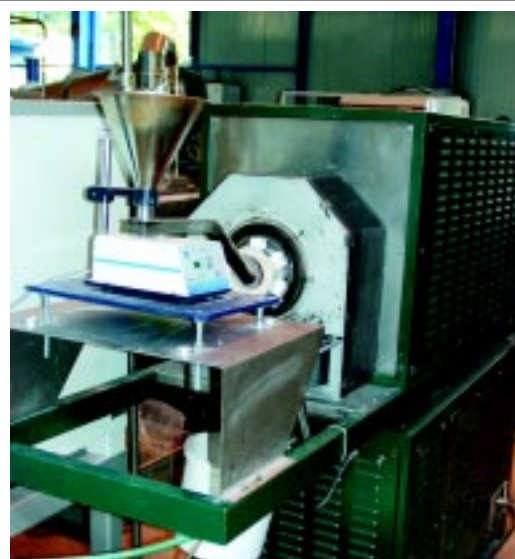
Bild 9: Drehofen mit Dosiervorrichtung im Technikum des Verfahrenstechnischen Instituts Saalfeld GmbH
