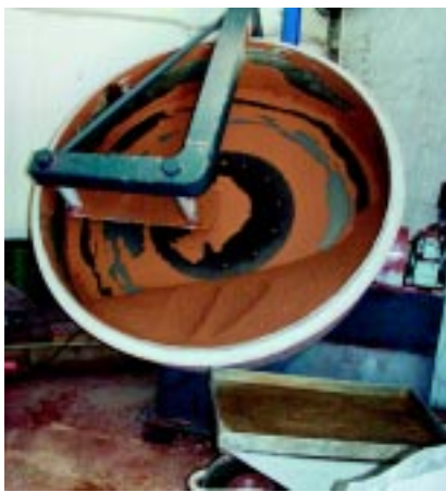
Bild 7: Granulierteller im Technikum des Verfahrenstechnischen Instituts Saalfeld GmbH
