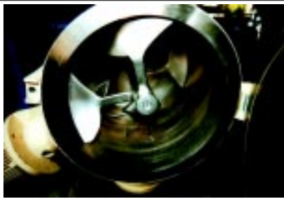
Bild 6: Pflugscharmischer mit Messerkopf im Aufbereitungstechnikum der Bauhaus-Universität Weimar
