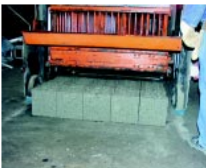
Bild 11: Steinfertiger und Steinlage nach einem Arbeitszyklus
